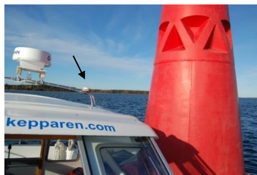
Pilen visar GPS-antennen
