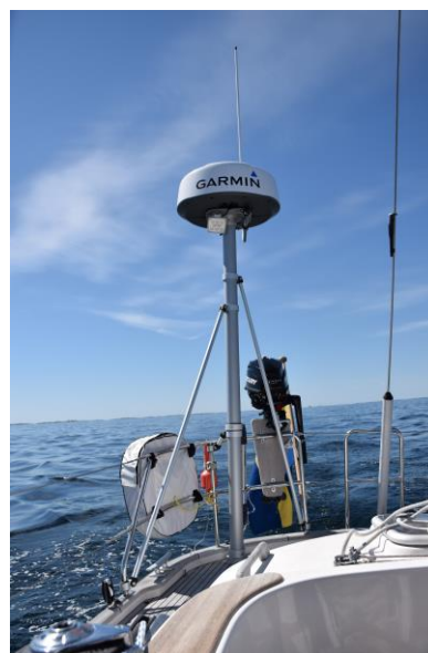
Radarn stör här VHF/AIS-antennen. Olyckligt monterat av mig.
