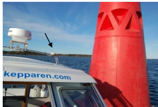
Pilen visar GPS-antennen
