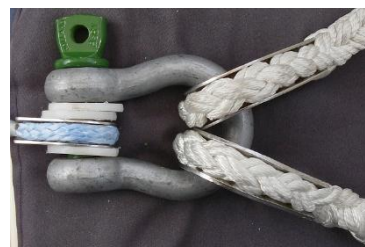
Förberedd draglina, schackel och hanfot till båtens akter.
