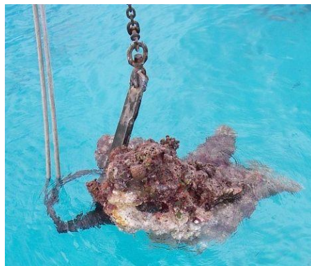
Stor korallklump. Tampen runt bygeln är för att kunna tippa av klumpen.
