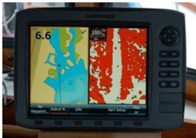
Avståndet är här 100 meter på radarn. Den första ringen visar 50 meter. Sidorna är täckta med vass och därför skiljer sig radarbilden från sjökortsbilden.
