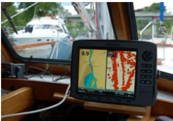
Motorbåten syns tydlig på radarskärmen trots att den är cirka 10 meter från radarantennen. Lägg märke till att bron syns både på radarskärmen och bilden. Kanalen är här cirka 25 meter bred.
